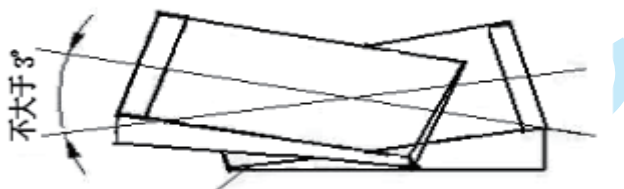
图 4.3.6 斜垫铁放置示意图
