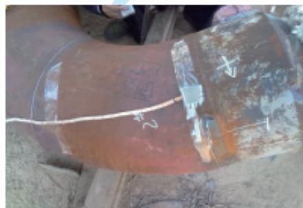
热电偶安装示意图
