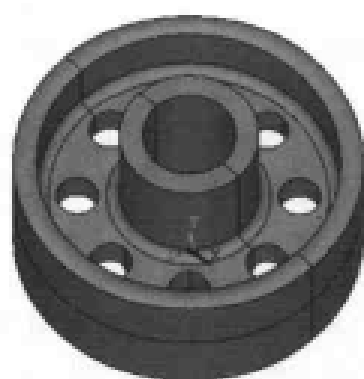
图 10-76 带轮结构示意图
