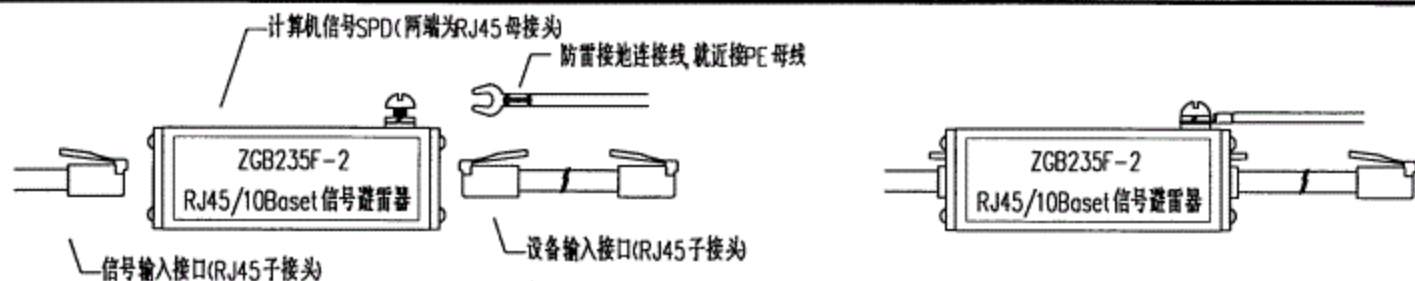
ZGB235F-2信号RJ45接口避雷器安装示意图
