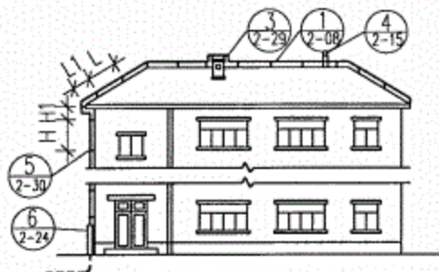
四坡顶防雷装置立面图
