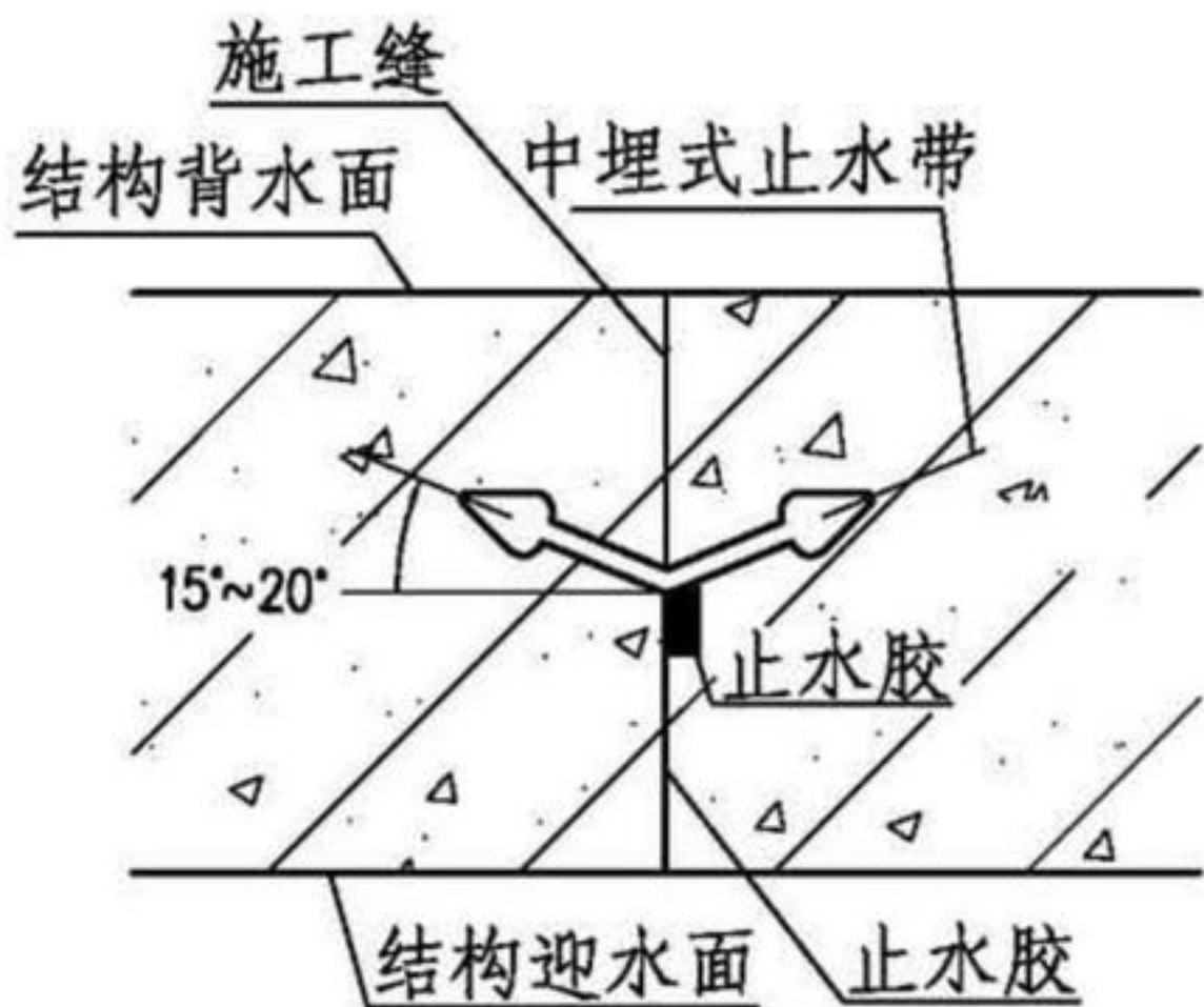
图5-37 顶板（环向）垂直施工缝防水构造示意图
